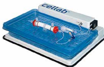
Cellab bioreaktor on väikeste mõõtmetega ning mahub standardsetesse inkubaatoritesse, samas võib reaktori sisemuse pindala ulatuda mitme ruutmeetri.
