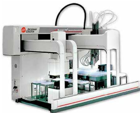
Biomek FXP on Biomek-seeria pipeteerimisrobotitest kõige võimekam.
